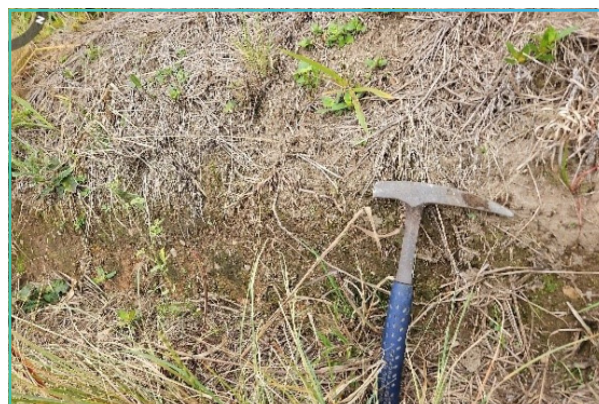
Perfil de solo classificado como cambissolo na área do Seccionamento da LT 525 kV Bateias – Ponta Grossa C1 na SE Curitiba Oeste
