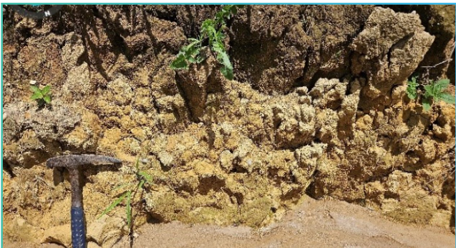
Perfil de solo classificado como cambissolo na área do Seccionamento da LT 525 kV Bateias – Ponta Grossa C1 na SE Curitiba Oeste
