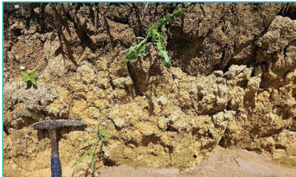
Perfil de solo classificado como cambissolo na área do Seccionamento da LT 525 kV Bateias – Ponta Grossa C1 na SE Curitiba Oeste
