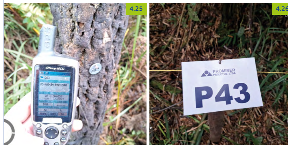
FOTO 4.25 Marcação dos pontos de coordenadas UTM de um dos vértices da parcela amostral do levantamento fitossociológico, mediante a utilização de aparelho GPS.
