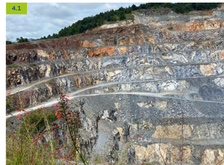
FOTO 4.1 Mina atual de calcário de Itaretama, onde é o minério extraído é usado para fabricação de cimento. O embasamento carbonático faz parte da Formação Antinha.
