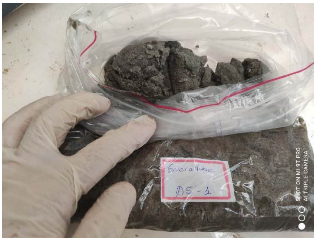
Foto 37 - PONTO A5-1 = Sedimento arenoso, cinza, com grãos finos a médios, com minerais pesados (pontos negros). Foto do autor.
