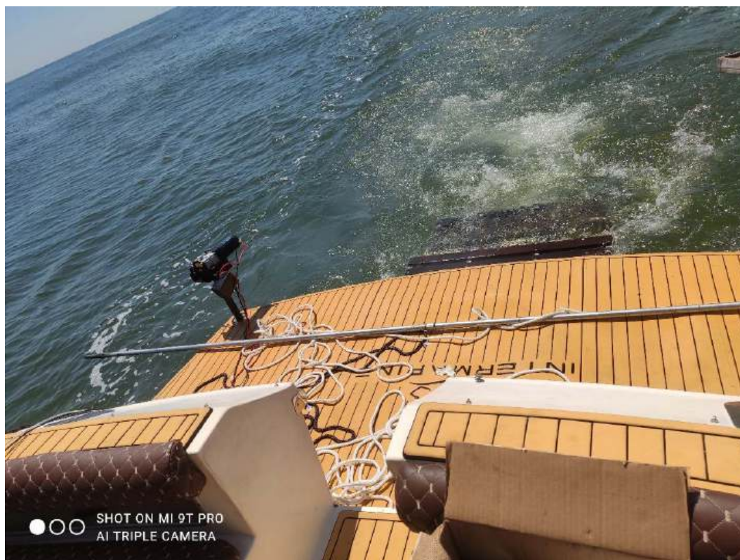
Foto 12 = Porção da popa do barco aonde observamos a barra mina, o cordamento e o guincho elétrico, durante os serviços de amostragens. Foto do autor.
