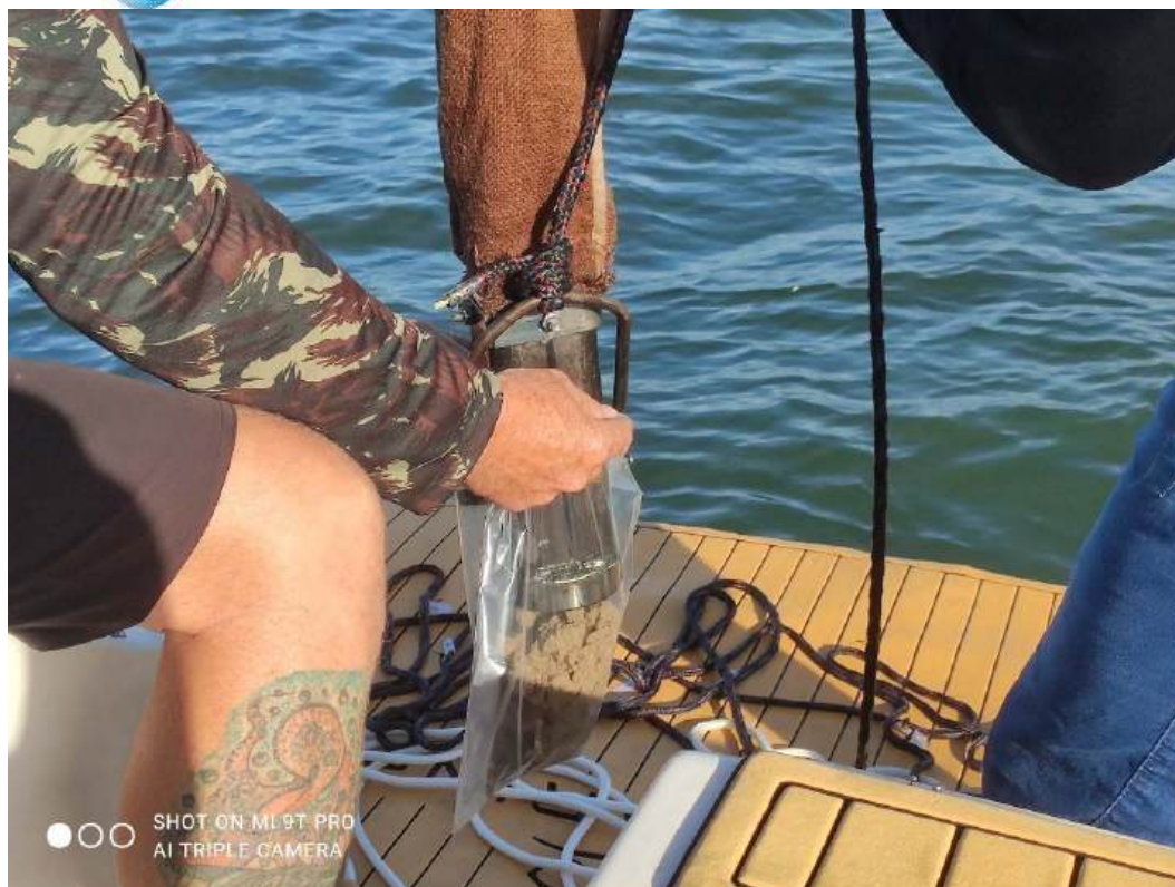
Foto 14 = Draga de arrasto de Gibbs, presa por uma corda graduada a cada metro, descarregando volumes de amostras de areia fina, na porção leste da área de pesquisa. Foto do autor.
