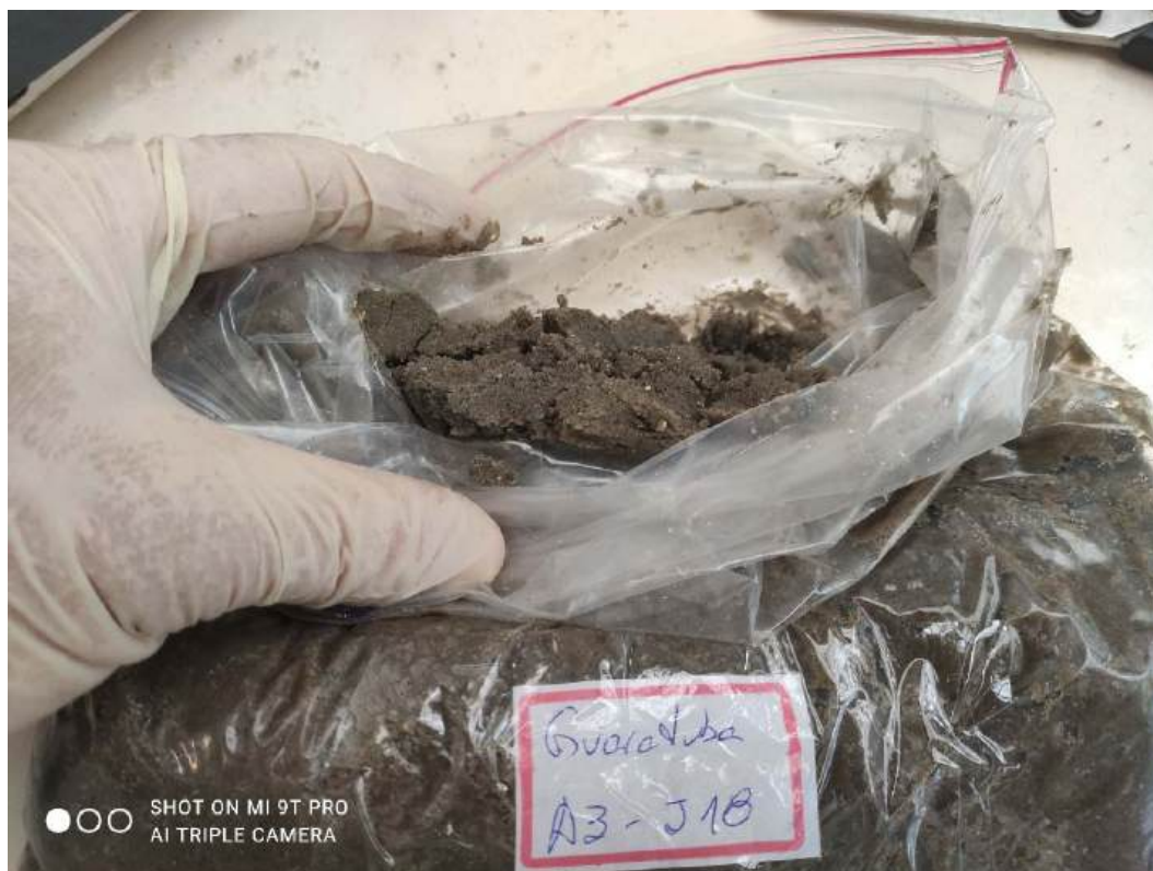
Foto 30 - PONTO A3-J18 = Sedimento arenoso, cinza escuro, com grãos finos a médios. Foto do autor.
