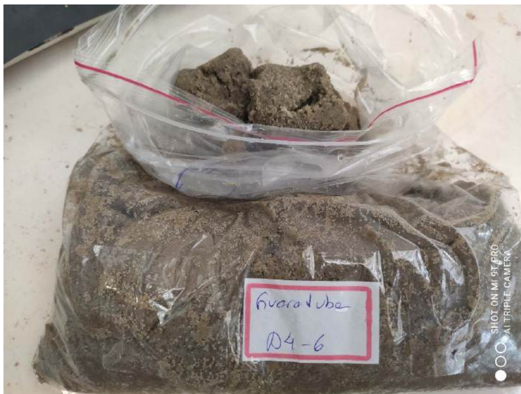
Foto 34 - PONTO A4-6 = Sedimento arenoso, cinza, com grãos médios a finos, com minerais pesados (pontos negros). Foto do autor.
