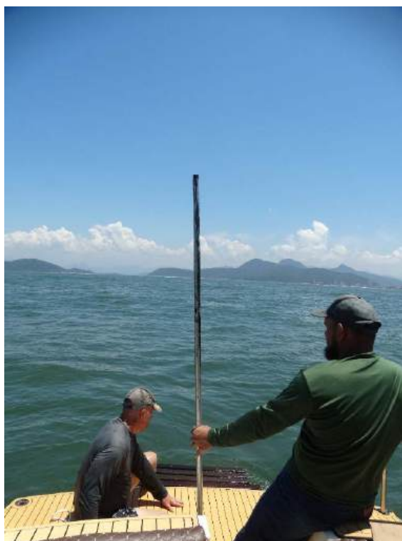
Foto 13 = Barra mina após amostragem em depósito lamoso, na porção noroeste da área de pesquisa. A coloração negra se deve à agregação da lama negra às hastes. Foto do autor.
