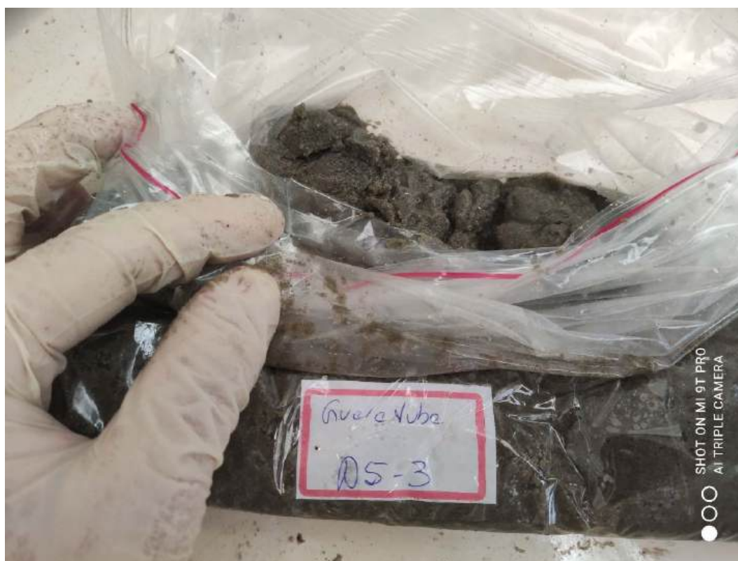
Foto 39 - PONTO A5-3 = Sedimento arenoso, cinza, com grãos finos a médios, com minerais pesados (pontos negros). Foto do autor.
