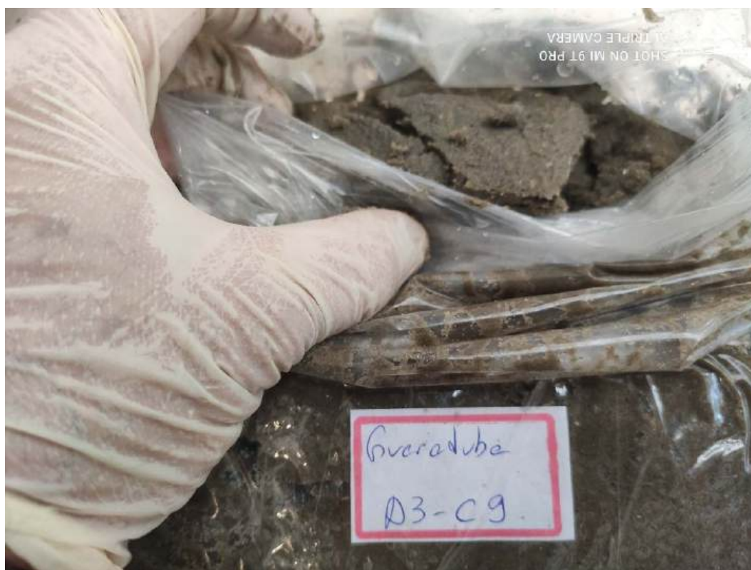
Foto 23 - PONTO A3-C9 = Sedimento arenoso, cinza claro, com grãos finos a médios. Foto do autor. Foto do autor.
