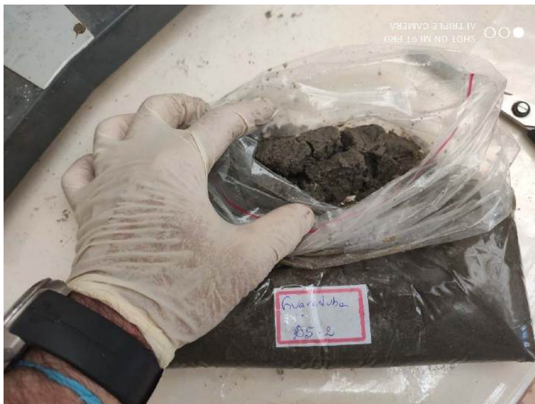
Foto 38 - PONTO A5-2 = Sedimento arenoso, cinza, com grãos finos a médios, com minerais pesados (pontos negros). Foto do autor.
