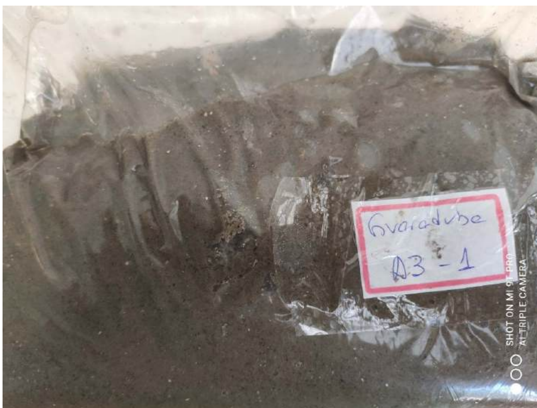
Foto 19 - PONTO A3-1 = Sedimento arenoso, cinza escuro, com grãos finos a médios além de argila/lama. Foto do autor.
