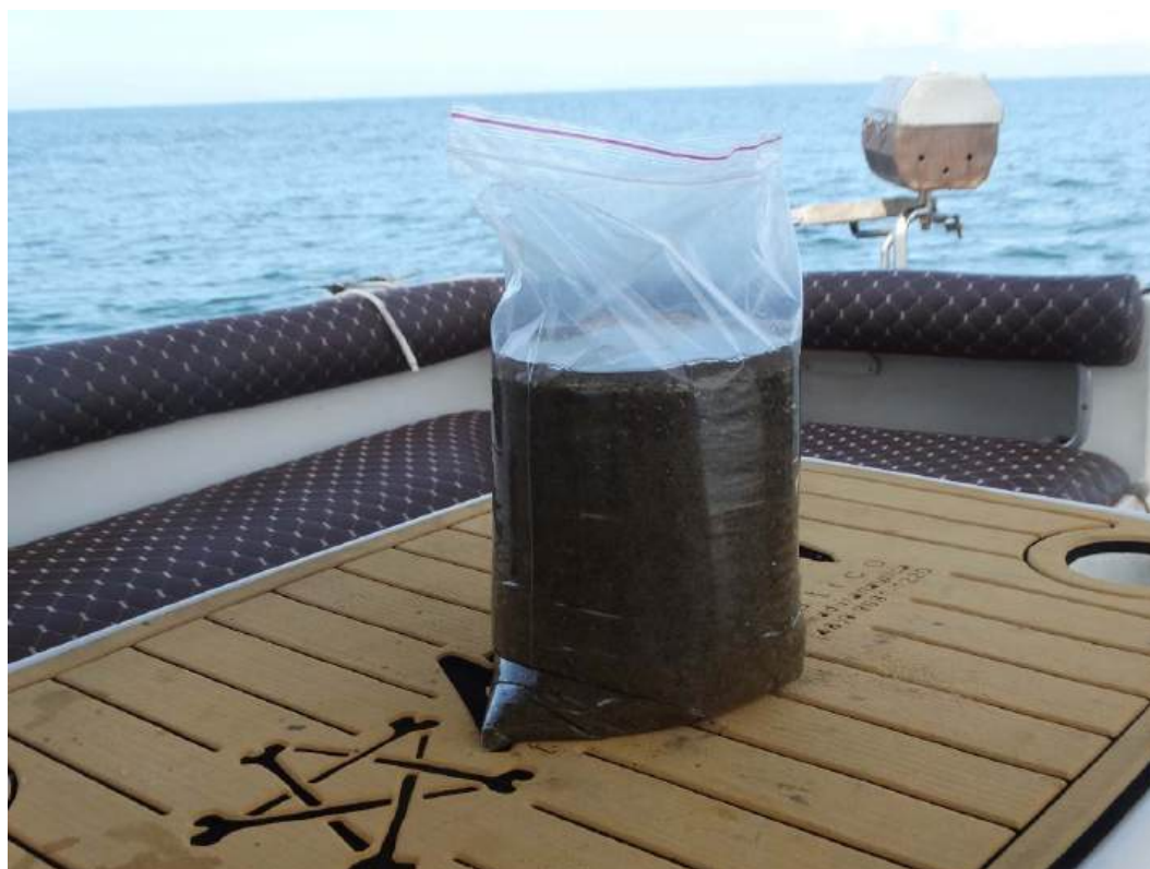
Foto 15 = Amostra obtida em um ponto com a utilização da draga de arrasto de Gibbs, transferido para um saco de plástico reforçado. Foto do autor.
