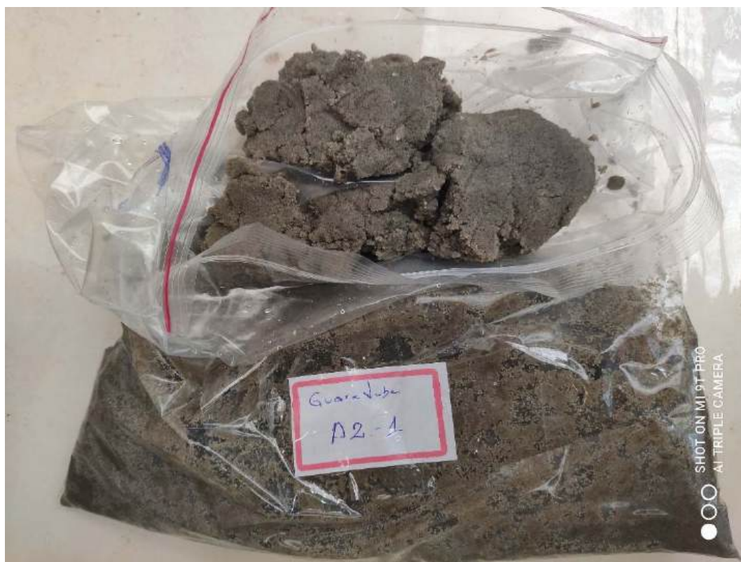
Foto 16 - PONTO A2-1 = Sedimento arenoso, cinza escuro, com grãos finos a médios, com minerais pesados (pontos negros). Foto do autor.
