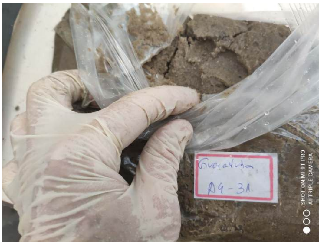
Foto 35 - PONTO A4-31 = Sedimento arenoso, cinza, com grãos médios a finos. Foto do autor.
