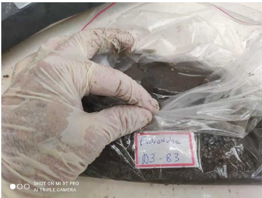
Foto 20 - PONTO A3-B3 = Sedimento arenoso, quase negro, com grãos finos a médios, além de lamas e argilas. Foto do autor.
