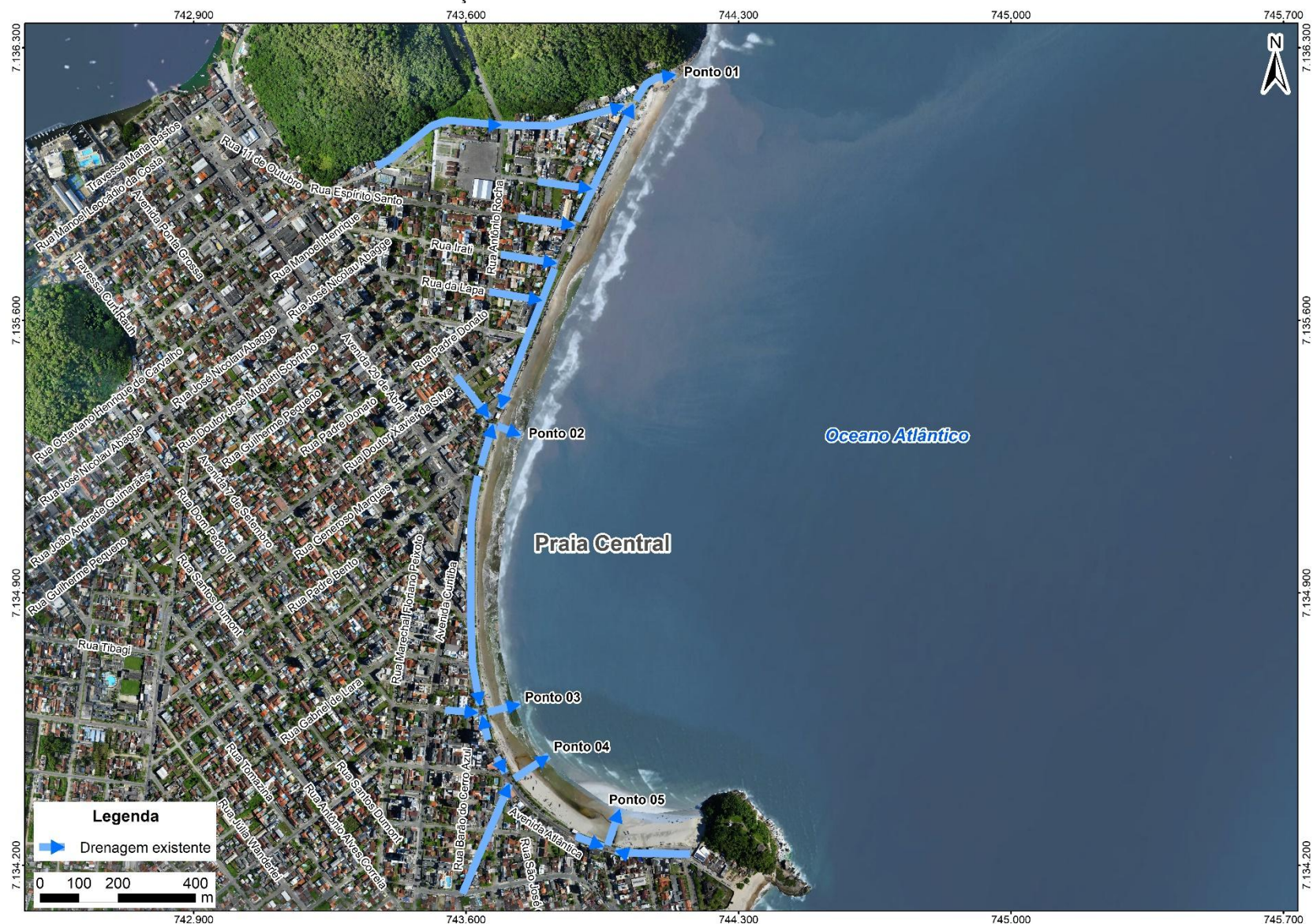
FIGURA 8 – SITUAÇÃO ATUAL DA DRENAGEM NA ORLA DA PRAIA CENTRAL
