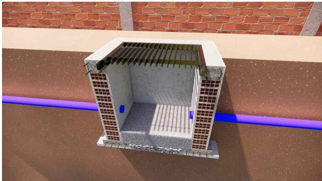
FIGURA 38 – EXEMPLO DE BOCA DE LOBO
