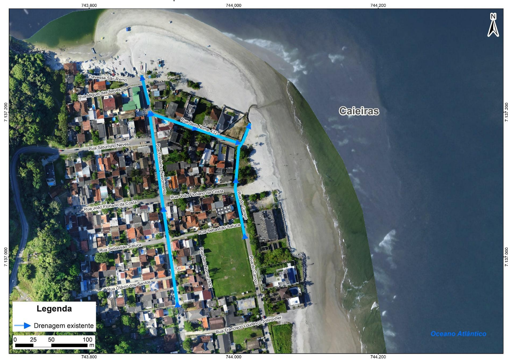
FIGURA 12 – SITUAÇÃO ATUAL DA DRENAGEM NA ORLA DA PRAIA DE CAIEIRAS
