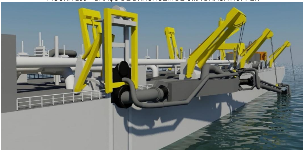
FIGURA 106 – BRAÇO DE DRAGAGEM DE UMA DRAGA HOPPER
