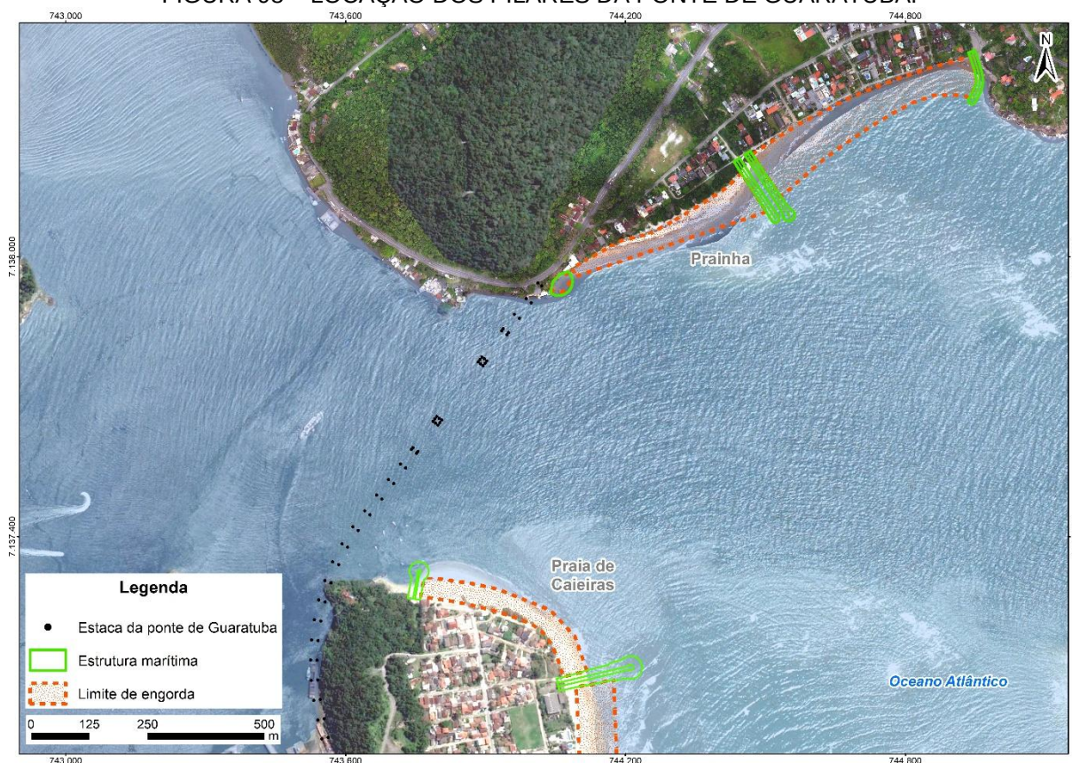
FIGURA 98 – LOCAÇÃO DOS PILARES DA PONTE DE GUARATUBA.
