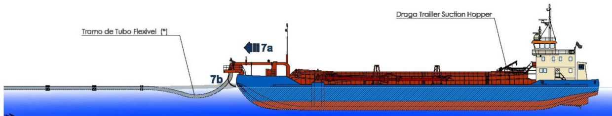
FIGURA 16 – FASE 4: POSICIONAMENTO DA DRAGA, ACOPLAMENTO DA LINHA DE RECALQUE E BOMBEAMENTO DA MISTURA (ÁGUA + SEDIMENTOS) ATÉ A FAIXA DE PRAIA
