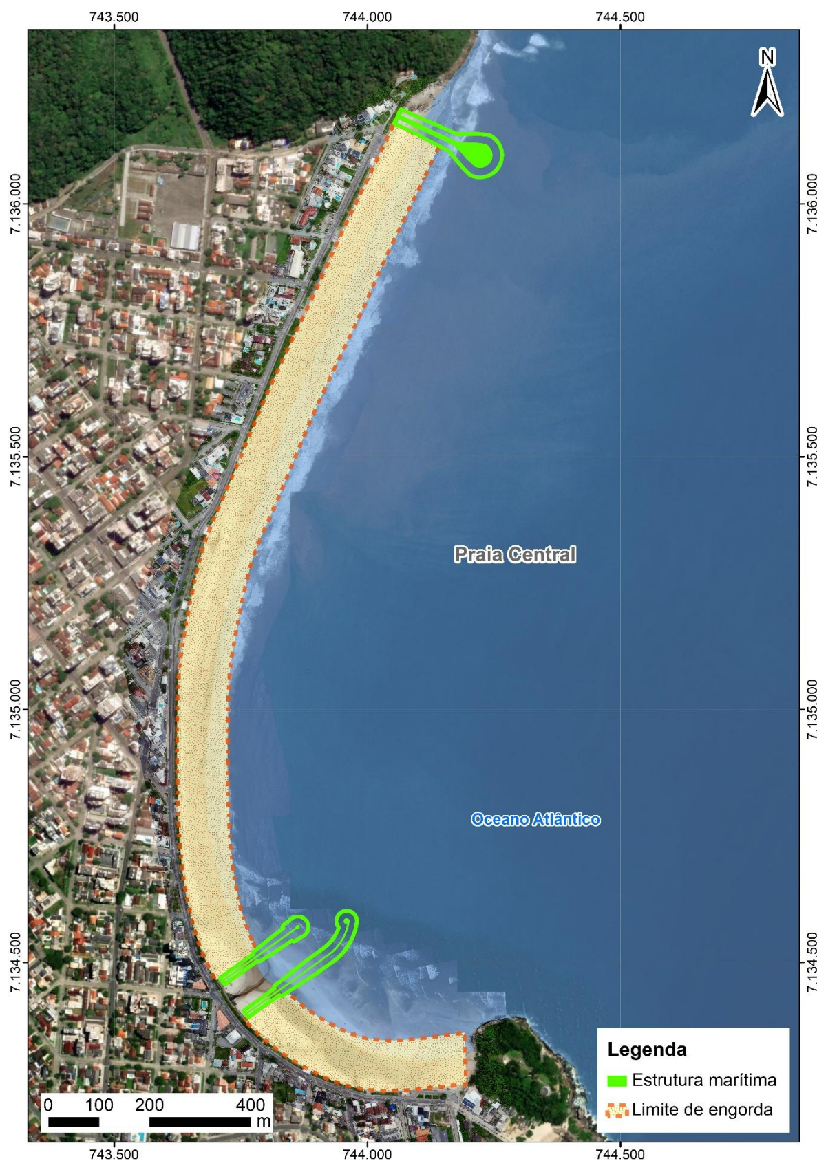
FIGURA 95 – ESTRUTURAS MARÍTIMAS PROPOSTAS PARA A PRAIA CENTRAL
