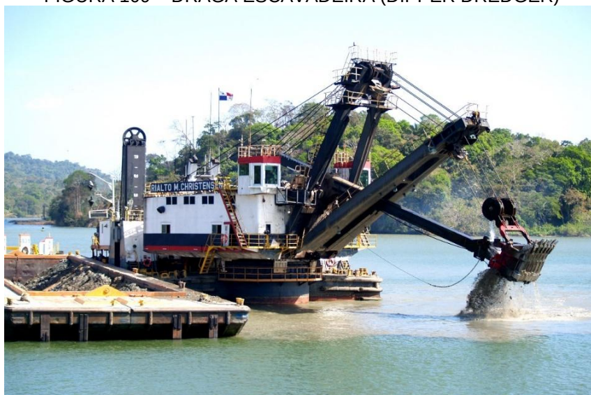
FIGURA 109 – DRAGA ESCAVADEIRA (DIPPER DREDGER)
