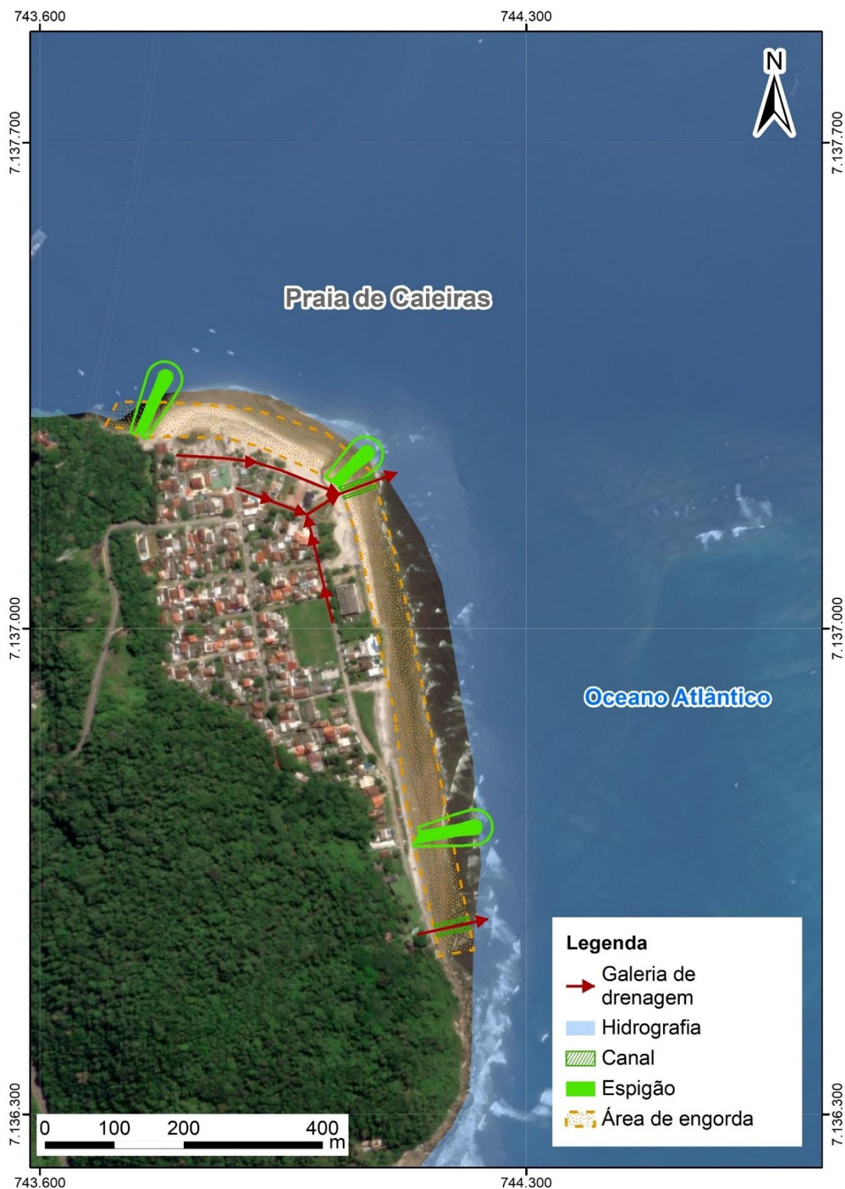
FIGURA 87 – ALTERNATIVA C DE OBRAS MARÍTIMAS E DRENAGEM NA ORLA DE CAIEIRAS
