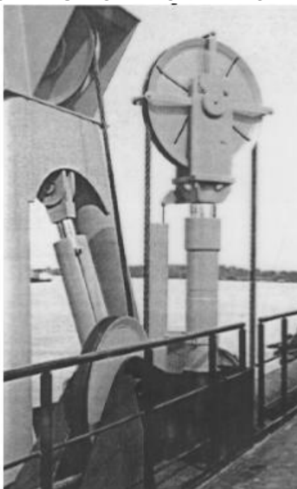
FIGURA 107 – COMPENSADOR DE ONDA DE UMA DRAGA HOPPER
