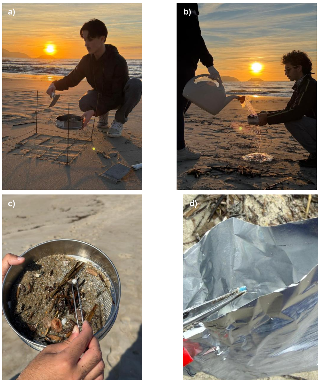
Figura 9. Procedimento de amostragem de microplásticos (1–5 mm) em sedimento de praia: (a) raspagem da camada superficial do sedimento; (b) peneiramento úmido em campo utilizando peneira de 1 mm; (c–d) separação, acondicionamento e armazenamento das partículas retidas em papel-alumínio.
