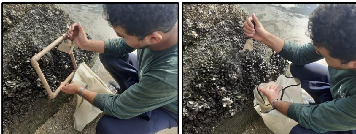
Figura 13 – Procedimento previsto para a obtenção de amostras de bentos de substrato consolidado em campo.
