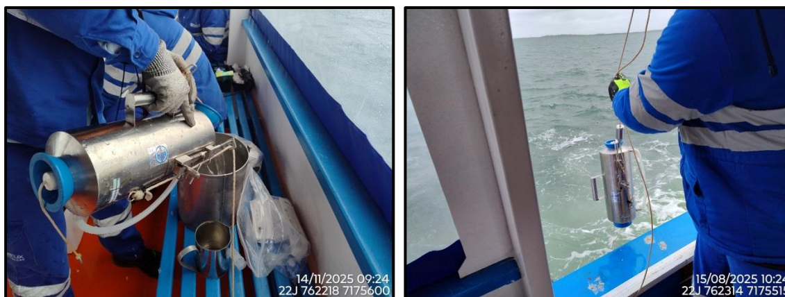
Figura 6 – Garrafa oceanográfica prevista para a coleta de fitoplâncton.
