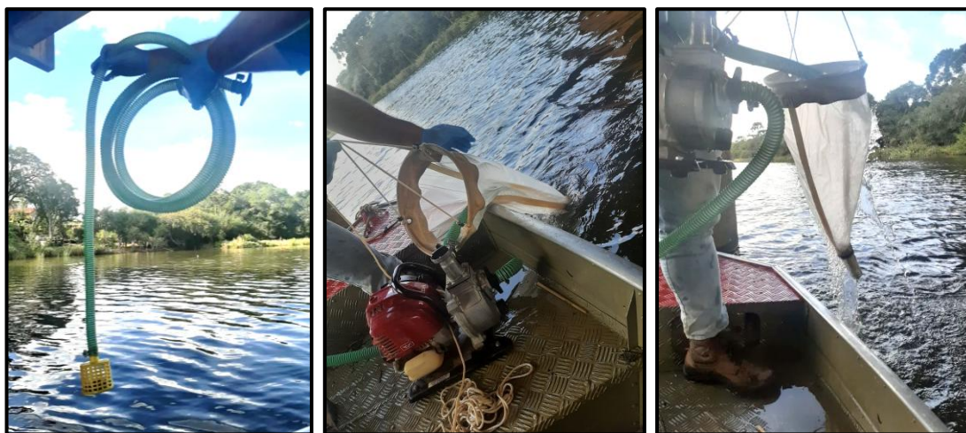
Figura 8 – Método de bombeamento previsto para a coleta de zooplâncton e ictioplâncton por estrato.
