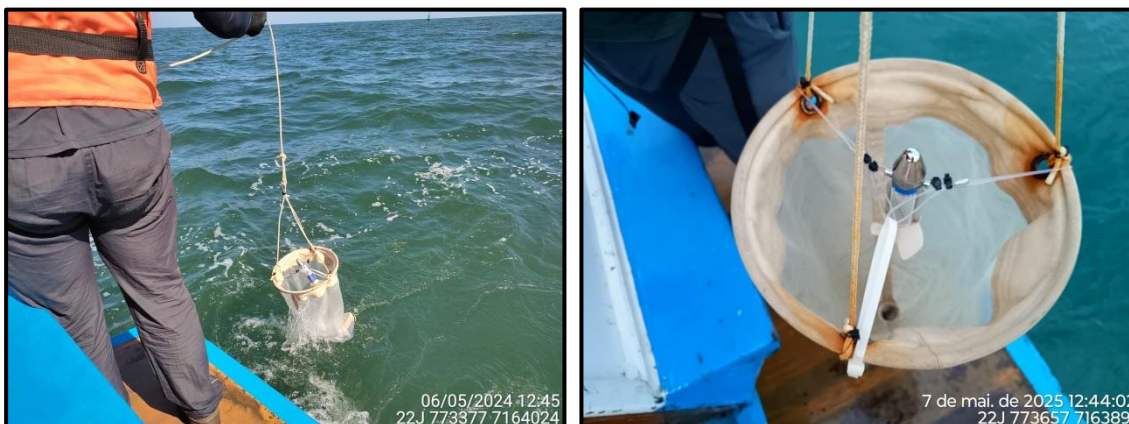
Figura 7 – Rede cilindro-cônica com fluxômetro prevista para a coleta de zooplâncton e ictioplâncton.
